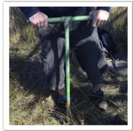
Figure 11 : Creusement à la tarière des piézomètres
